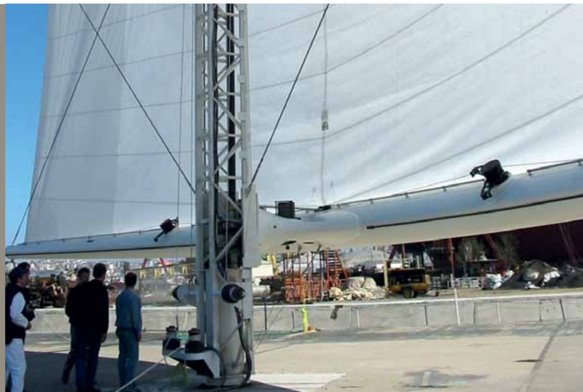
Testopstelling voor het Dynarig ontwerp zoals toegepast bij het zeiljacht Maltese Falcon.
