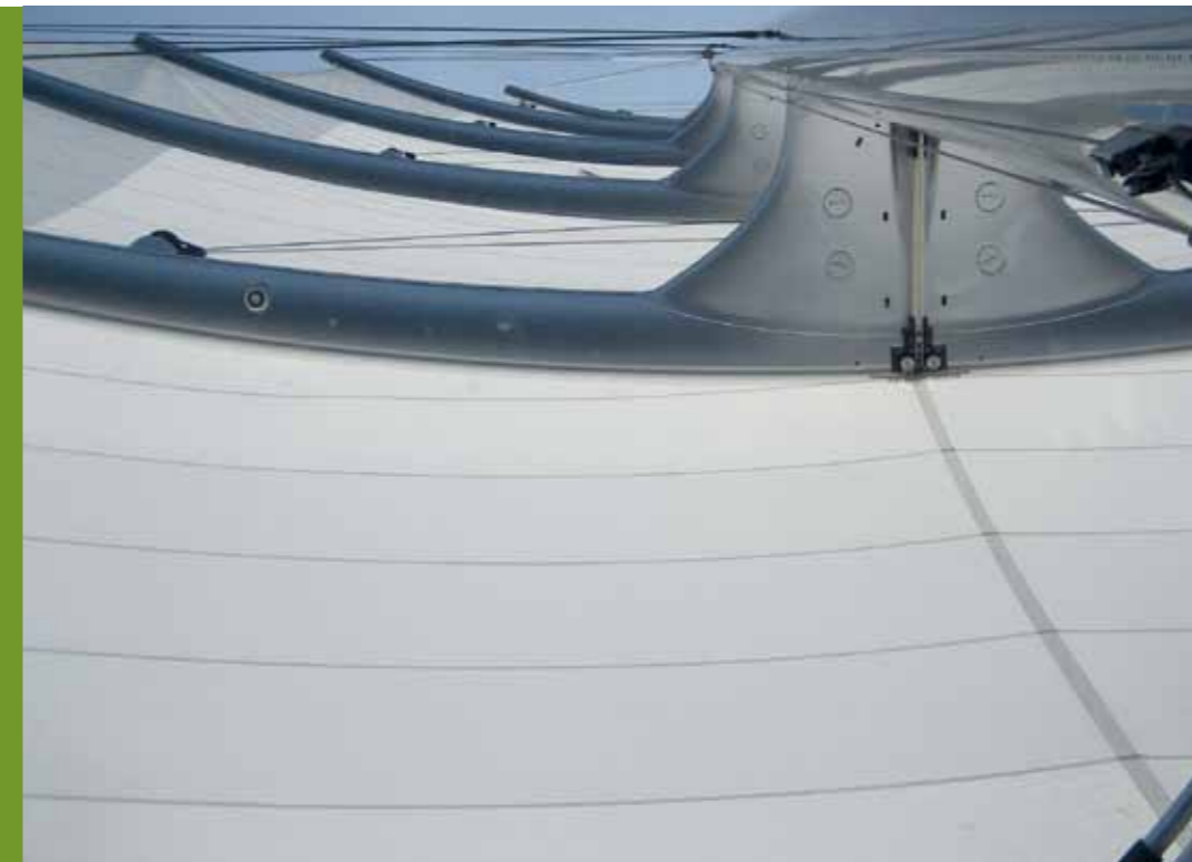
Het geoptimaliseerde aerodynamisch profiel van het Dynarig maakt het een zeer efficiënt tuig ten opzichte van traditionele dwars tuigage.
