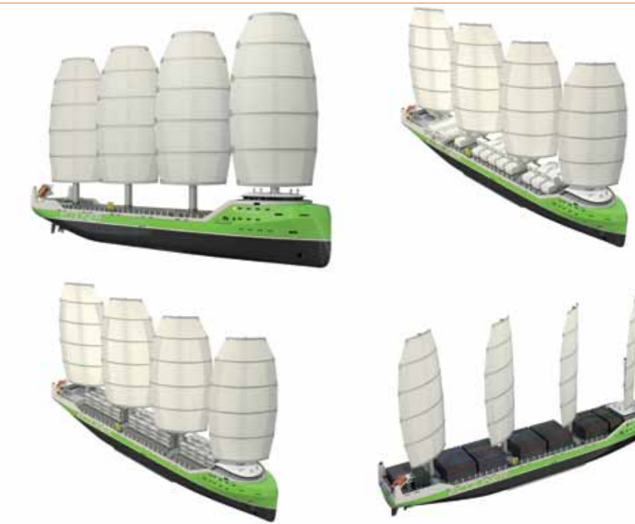
Met de klok mee: Ecoliner als bulkschip, containerschip en tanker
